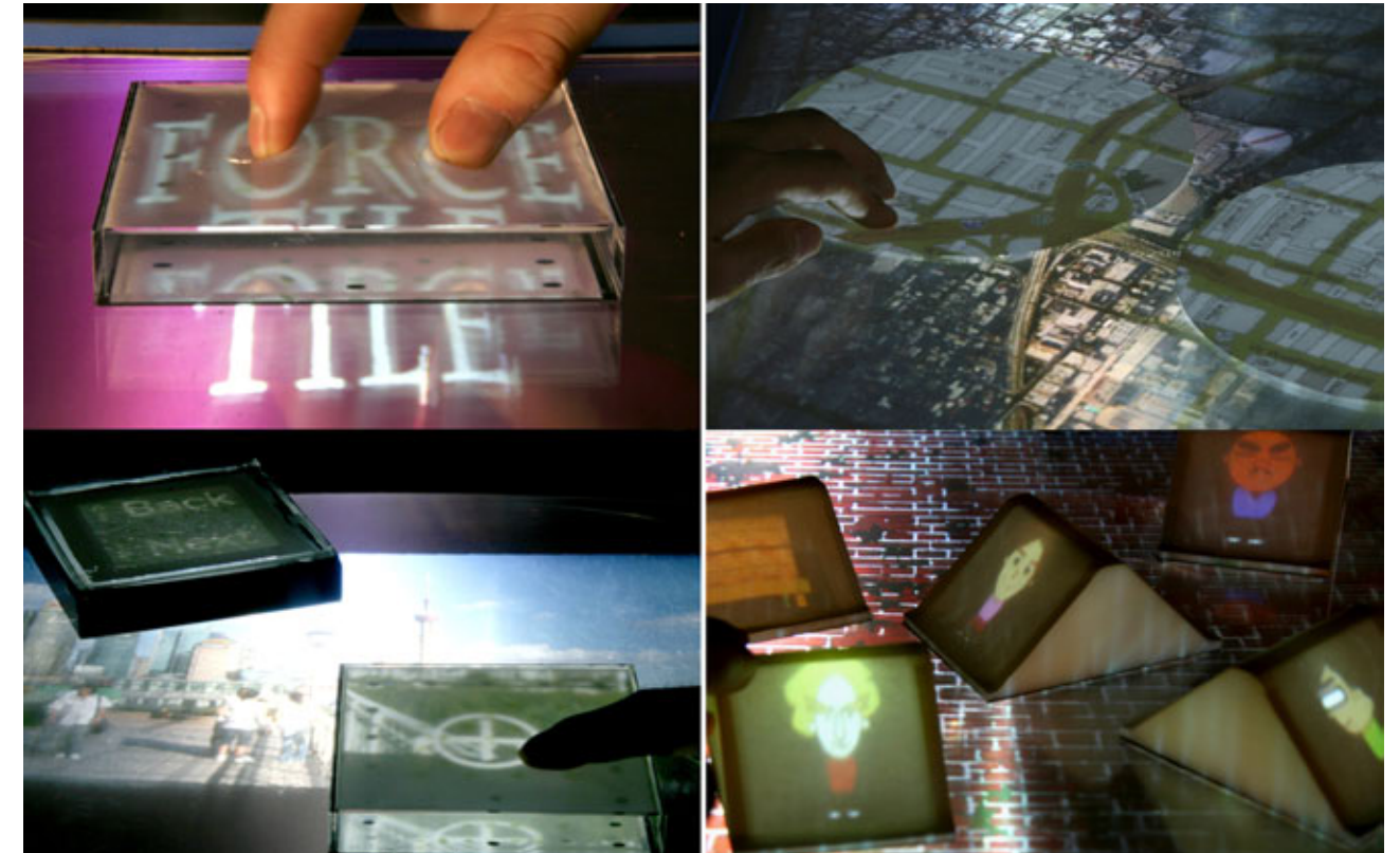
図2. カベクトル入力可能なタンジブルインタフェース、ForceTile(左)とインタラクティブな映像重畳ディスプレイ、UteriorScape(右)
