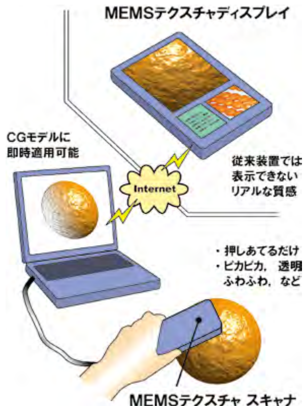
図1. 実際の物体の表面に押し当てただけでテクスチャ(質感)情報を取り込んで、コンピュータグラフィックス(CG)に適用できるシステムです。最終的には質感ディスプレイも開発して総合的なテクスチャシステムをめざしています。
