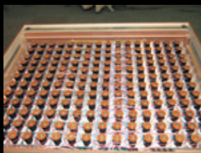
ディスプレイ内部 192個の電磁石を個別に制御
