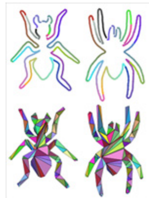
図 22 TVCG 論文の結果。 アウトラインをまず選択し、数点の対応点を指定後に、すべてのアウトラインの対応点を自動的に発生させる(上図)。それをもとに形状内部を自動的に三角形分割する。これにより、滑らかで自然なモーフィングが可能となる。
